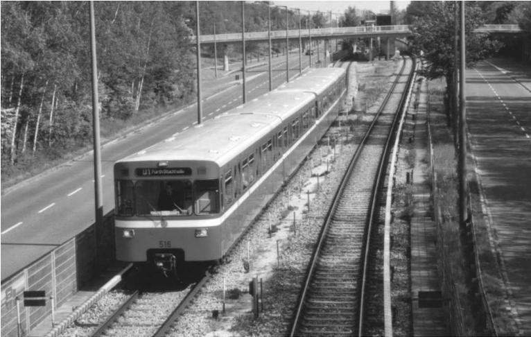
*Abb.17: Natürlich können die Nürnberger U-Bahn-Wagen auch oberirdisch fahren. Der erste Bauabschnitt in Langwasser, der 1972 eröffnet wurde, hatte sogar nur einen etwa 1 km langen Tunnel. Die seitliche Stromschiene erfordert aber eine hermetische Abriegelung, so dass alle Wege und Straßen niveaufrei auf Brücken oder Unterführungen kreuzen müssen. Die Baukosten sind dadurch auch auf oberirdischen Abschnitten wesentlich höher als bei einer Stadtbahn oder Regionalbahn.*
